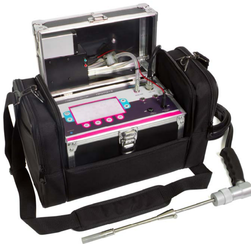
Газоанализатор «Протон-2 Универсал про» в транспортировочной сумке готов к работе
